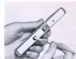
Objektivfenster mit Wattestäbchen reinigen – oder mit sauberem Läppchen (um ein Streichholz wickeln).
