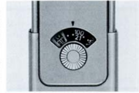
Filmempfindlichkeitskala, eingestellt auf ASA 80/20 DIN
