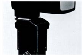
Mittenkontakt-Blitzschuh (im Bild auf einer Minox C)
