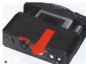
Öffnen Sie jetzt bitte die Frontklappe der Camera, damit Sie den Auslöser betätigen können. Betätigen Sie den Filmtransport so weit (falls notwendig, zwischendurch Auslöser drücken), daß an der Filmaufwickelspule der breite offene Schlitz der Spulenhülse leicht zugänglich ist. Drücken Sie jetzt den Entsperrknopf (Unterseite der Camera rechts), da-
