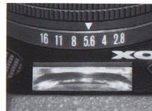
Eine hohe Blendenzahl (z.B. 11 oder 16) bezeichnet eine kleine Blendöffnung, eine niedrige Blendenzahl (z.B. 2,8 oder 4) eine große Blendöffnung. Je höher die Blendenzahl, desto größer ist die Schärfentiefe (der Entfernungsbereich, in dem die Aufnahmen eine ausreichende Schärfe aufweisen), desto länger ist aber die Belichtungszeit.
