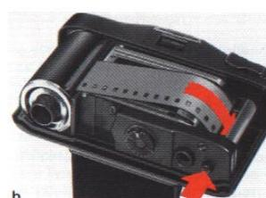
mit sich die Spule nicht dreht. Schieben Sie den Filmanfang so weit wie irgend möglich unter die metallfarbene Hülse (Bild b). Entsperrknopf loslassen.
