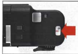
Bildzähler auf Startstellung (Stellung zum Einlegen eines Filmes).
